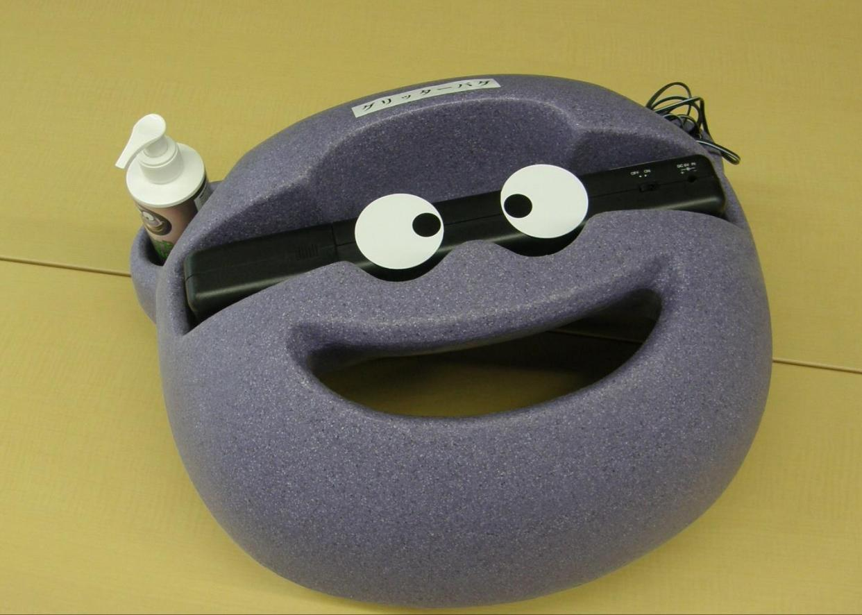
専用ローションを塗り、日頃の手洗いを実施後、ボックス内に手をかざすと洗い残し部分を目で確認できます。現場で適切な手洗いが出来ているか、評価できます。院内の感染防止関連の研修等にご活用ください。
