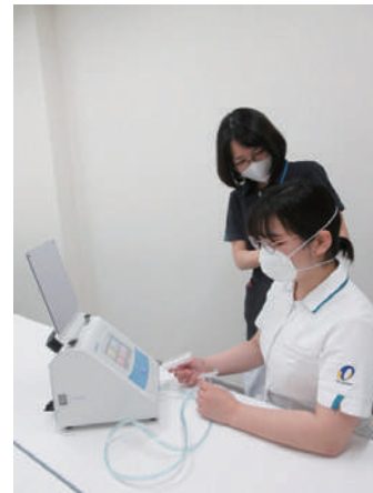
専用の測定機器を用いた N95 マスクフィットテストの場面
